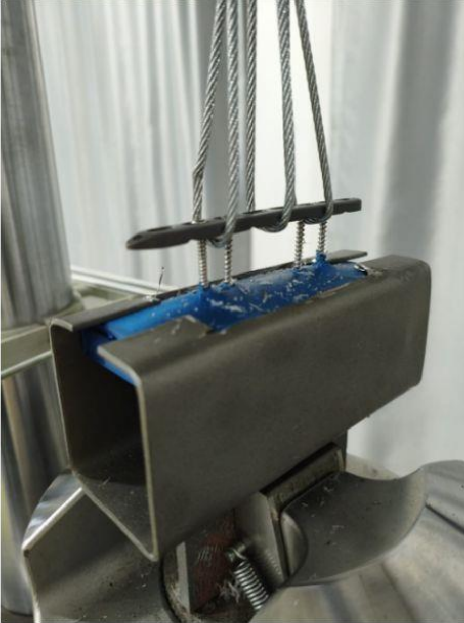
Yapılan pull-out testlerinde vida çıkış anını gösteren resim
